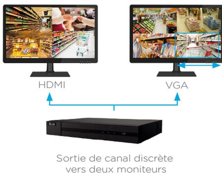
Avec certains modèles de NVR qui permettent une sortie de canal vidéo séparée sur plusieurs moniteurs, vous pouvez surveiller plusieurs canaux simultanément et plus facilement.
